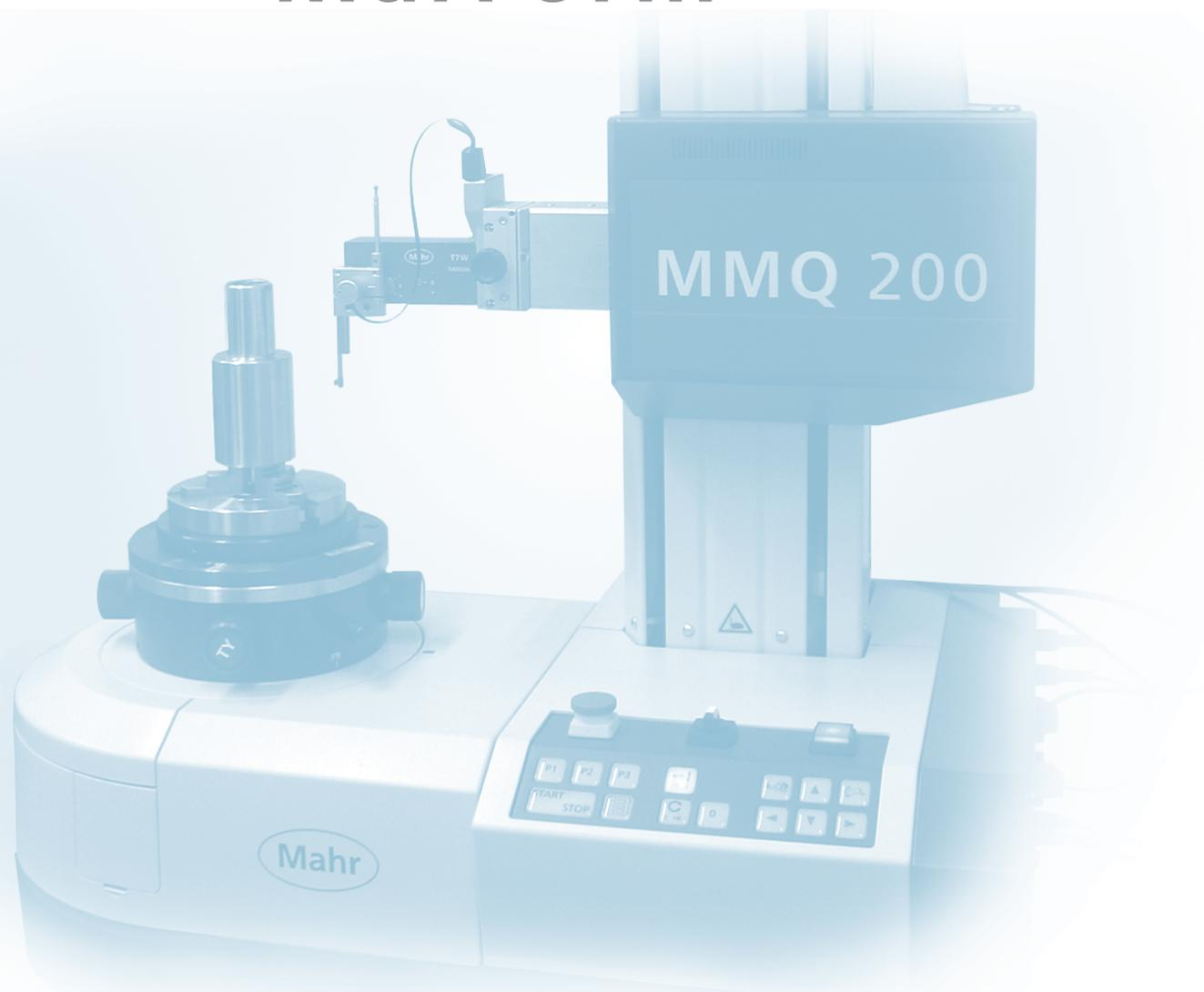
**Nouvelle Option:** Mesure d'état de surface suivant les normes avec le MarForm MMQ 200 !
